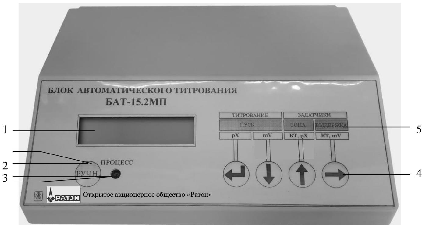
1 – дисплей; 2 – кнопка «РУЧН»; 3 – светодиодный индикатор «Процесс»;
